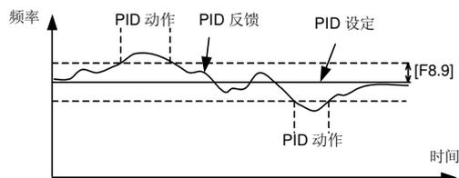
图 6-32 PID 控制允许偏差限值
