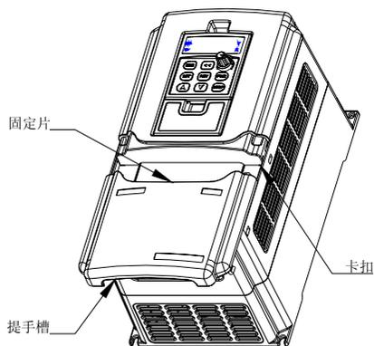
图 2-3-A 塑壳盖板的拆卸与安装
