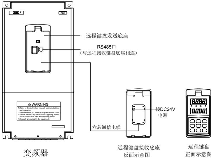
图 C-5 远程键盘连接示意图
