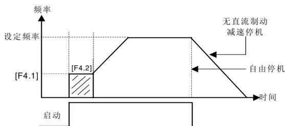
图 6-17 启动与停机频率输出曲线
