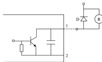
图 6-13 OC 输出端子的内部线路
