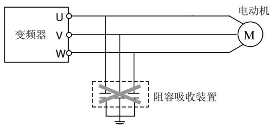
图 3-1 输出端禁止连接阻容吸收装置
