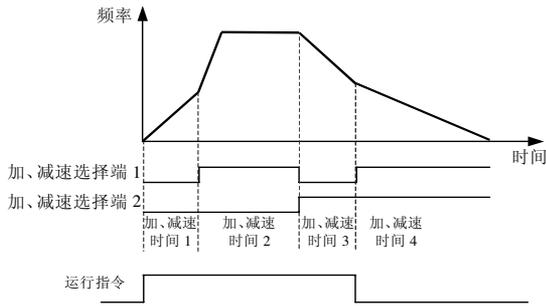
图 6-22 加、减速时间的外部端子选择方式
