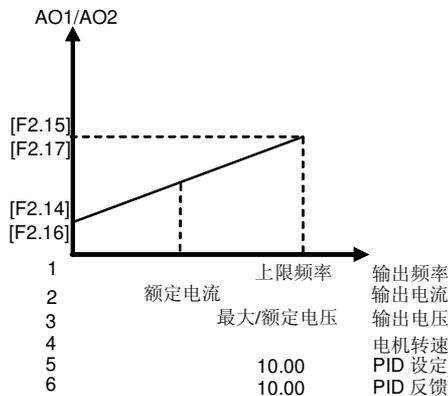
图 6-11 模拟输出端子的模拟输出内容
