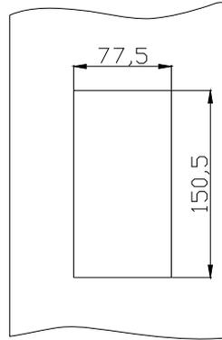
图 C-9 安装尺寸：150.5×77.5mm
