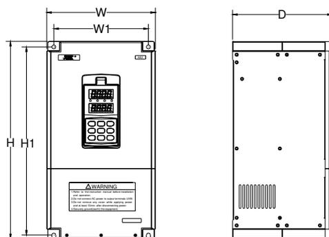
图 2-4-B 变频器的安装尺寸
