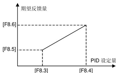
图 6-31 PID 给定量与反馈量的关系
