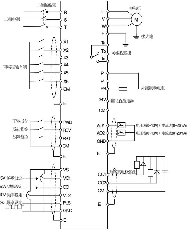
图 3-3 AE2 系列变频器基本接线图
