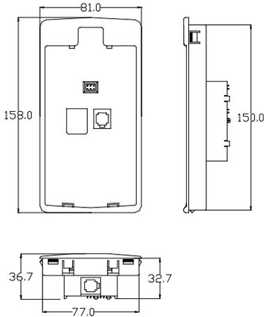
图 C-1 操作面板安装底座的尺寸
