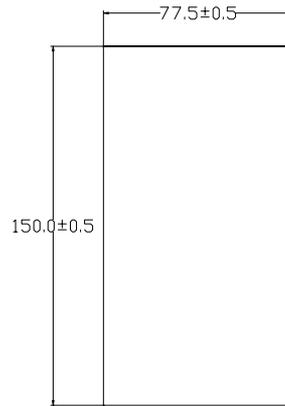
图 C-2 操作面板底座安装开孔尺寸
