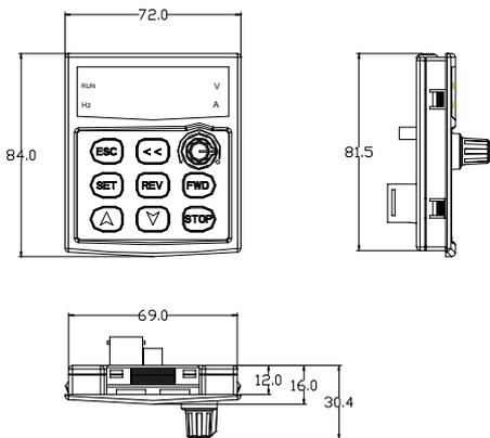
图 C-3 小操作面板安装底座的尺寸
