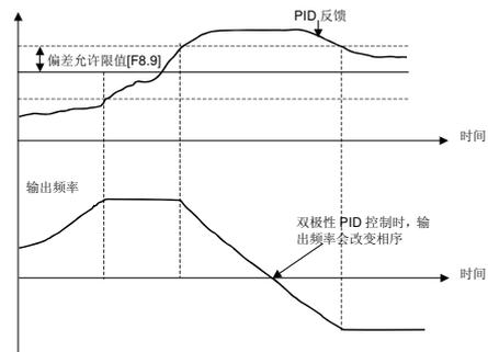
图 6-30 双极性 PID 控制方式
