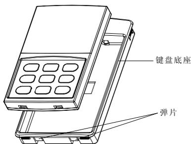
图 2-2 操作面板的拆卸和安装
