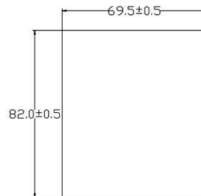
图 C-4 小操作面板底座安装开孔尺寸
