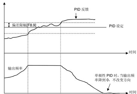
图 6-29 单极性 PID 控制方式
