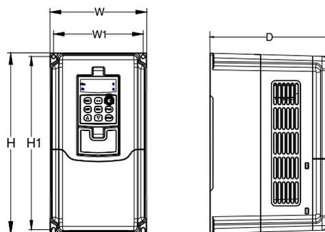
图 2-4-A 变频器安装尺寸
